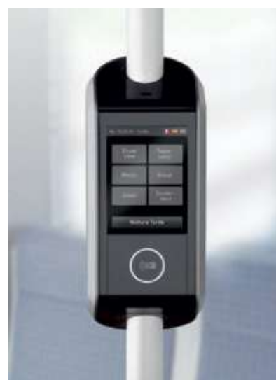
Figura 116: Exemple pentru dispozitive la bord (validator bilete, validator pentru E-Ticket) Sursa: IVU Traffic Technologies
