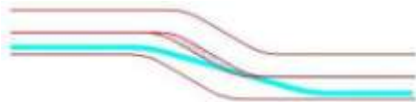
A4.Figura 9: Amenajarea șicanelor și a zonelor de separare a sensurilor de circulație în curbe (Sursă: Search Corporation- Catalog de măsuri pentru siguranța circulației în satele liniare, 2007)
